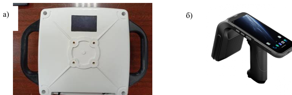
Рис. 1. Считыватели для контроля изоляторов воздушной линии электропередачи: а) считыватель разработки «УЦДО СКЛ», б) мобильный универсальный считыватель Chainway C5 UHF RFID-reader
