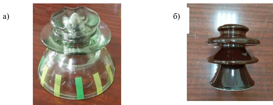
Рис. 2. Изоляторы с закрепленными RFID-метками: а) стеклянный штыревой ШС 10, б) фарфоровый штыревой ШФ 20 Г
